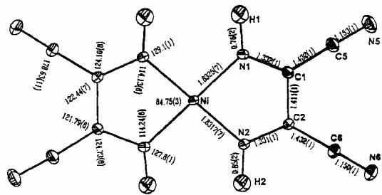
圖一  $\text{Ni}(\text{N}_4\text{C}_4\text{H}_2)_2$  分子結構圖。
