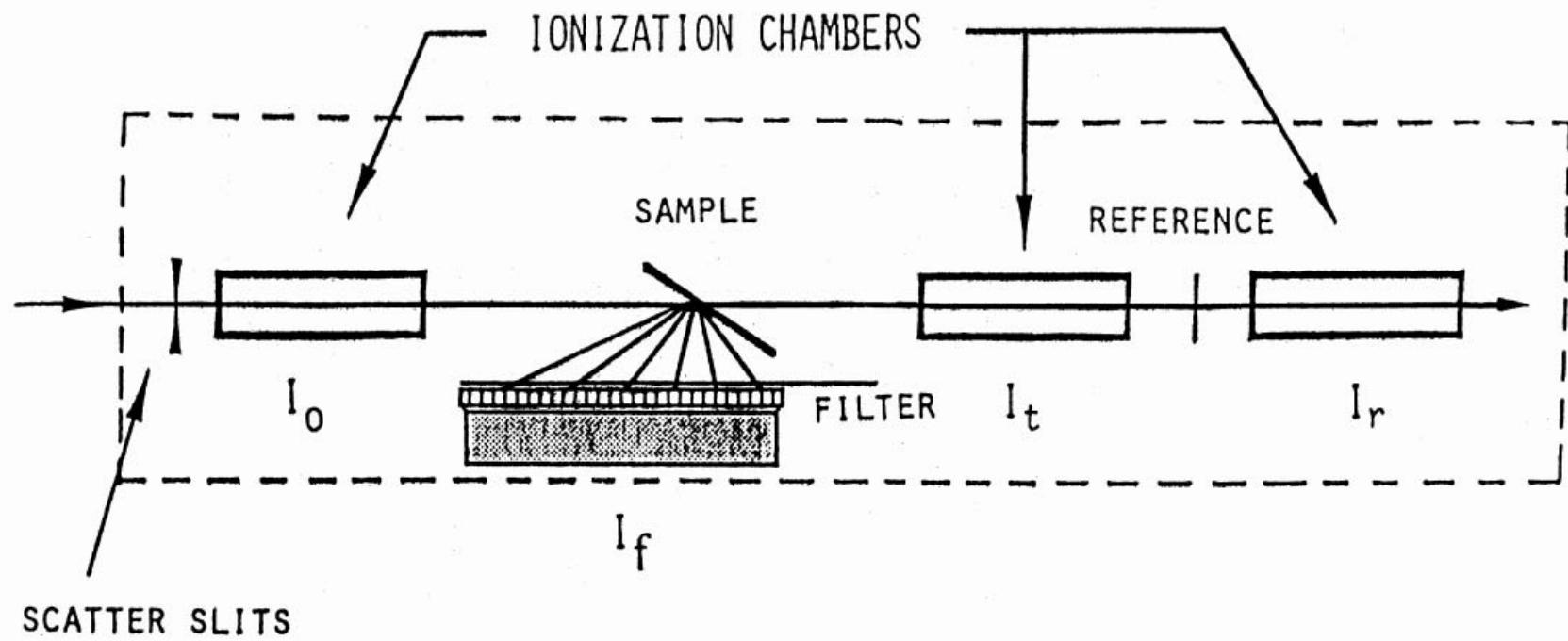
典型的 X 光吸收光譜術實驗配置圖 (其中虛線表示實驗站的輻射屏蔽屋)
